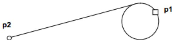
Рис. 1.10. Построение отрезка, касательного к окружности
